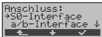
Im Menü Anschluss muss als physikalischer Anschluss **S0-Interface** ausgewählt werden
