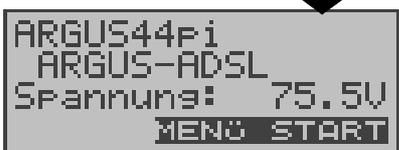
ARGUS zeigt den eingestellten Anschluss-Modus ARGUS-ADSL und die Gleichspannung der Anschluss-Schnittstelle an.
