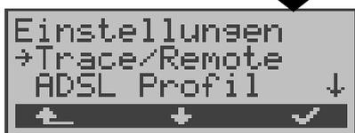
Kann ARGUS die Daten nicht fehlerfrei zum PC senden, blinkt die LED „Trace“ im 5Hz-Takt (5mal pro sec).
