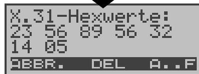
Über die Zifferntasten der Tastatur Hexwerte eintragen. Für die Eingabe der Werte A..F den Softkey <A..F> verwenden (z.B. bei Eingabe von C Softkey <A..F> 3mal drücken). Die Eingabe der Hex.ziffern A bis F mit <OK> bestätigen (der mittlere Softkey ändert seine Bedeutung von <DEL> auf <OK>). Mit <DEL> : Stelle vor dem Cursor löschen.
