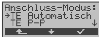
Das Menü Anschluss-Modus ist **nicht** aus dem Hauptmenü heraus wählbar. Es öffnet sich automatisch nach Auswahl des physikalischen Anschlusses im Menü Anschluss.
