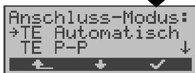
Es öffnet sich automatisch das Menü Anschluss-Modus: Für den  $U_{k0}$ -Anschluss muss der Anschluss-Modus TE Automatisch, TE P-P, TE P-MP oder Festverbindung ausgewählt werden.
